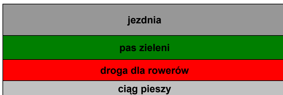
Rys. 5.2 Przykład usytuowania drogi dla rowerów częściowo oddzielonej (tylko od ruchu samochodowego).
