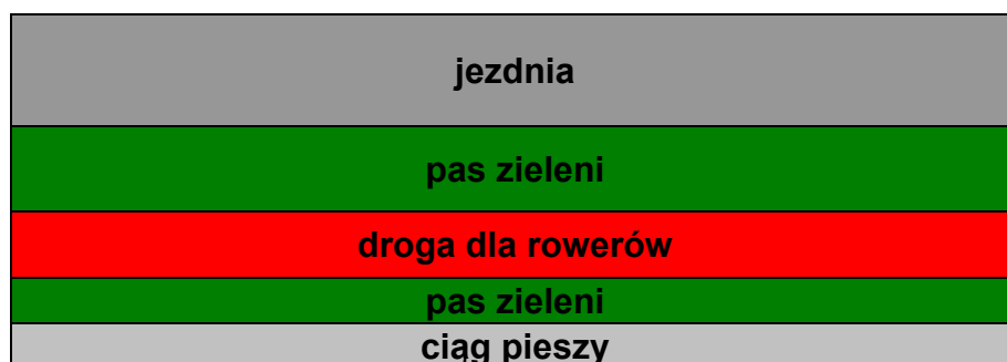
Rys. 5.1 Przykład usytuowania drogi dla rowerów całkowicie oddzielonej od ruchu samochodowego i pieszego.
